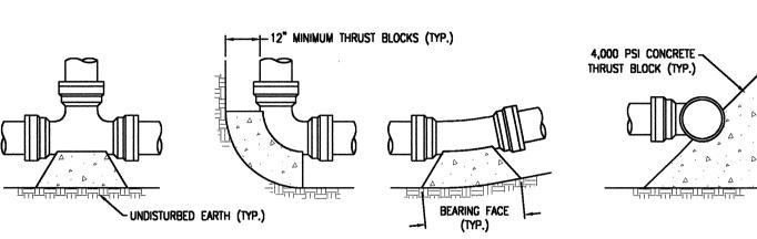
AT BEND TYPICAL ELEVATION
